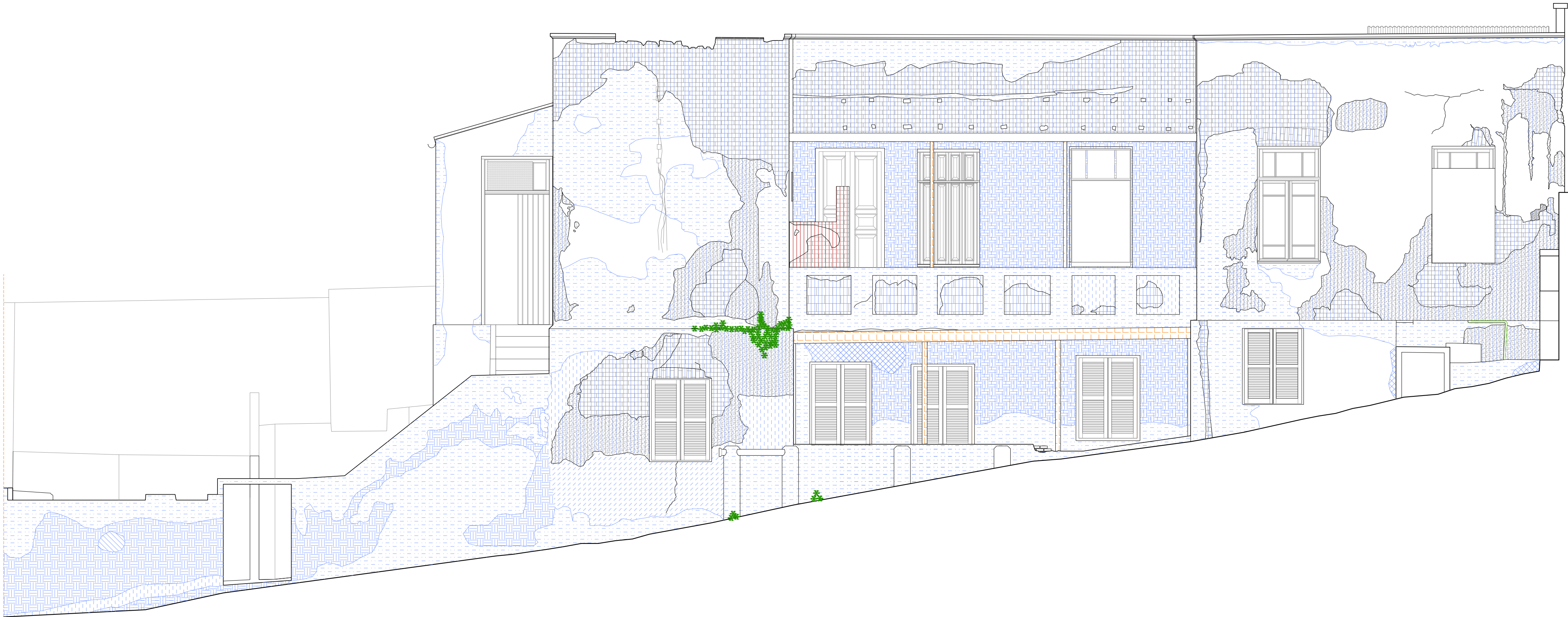
Elevação 1 | Mapeamento de Danos Escala 1:50
