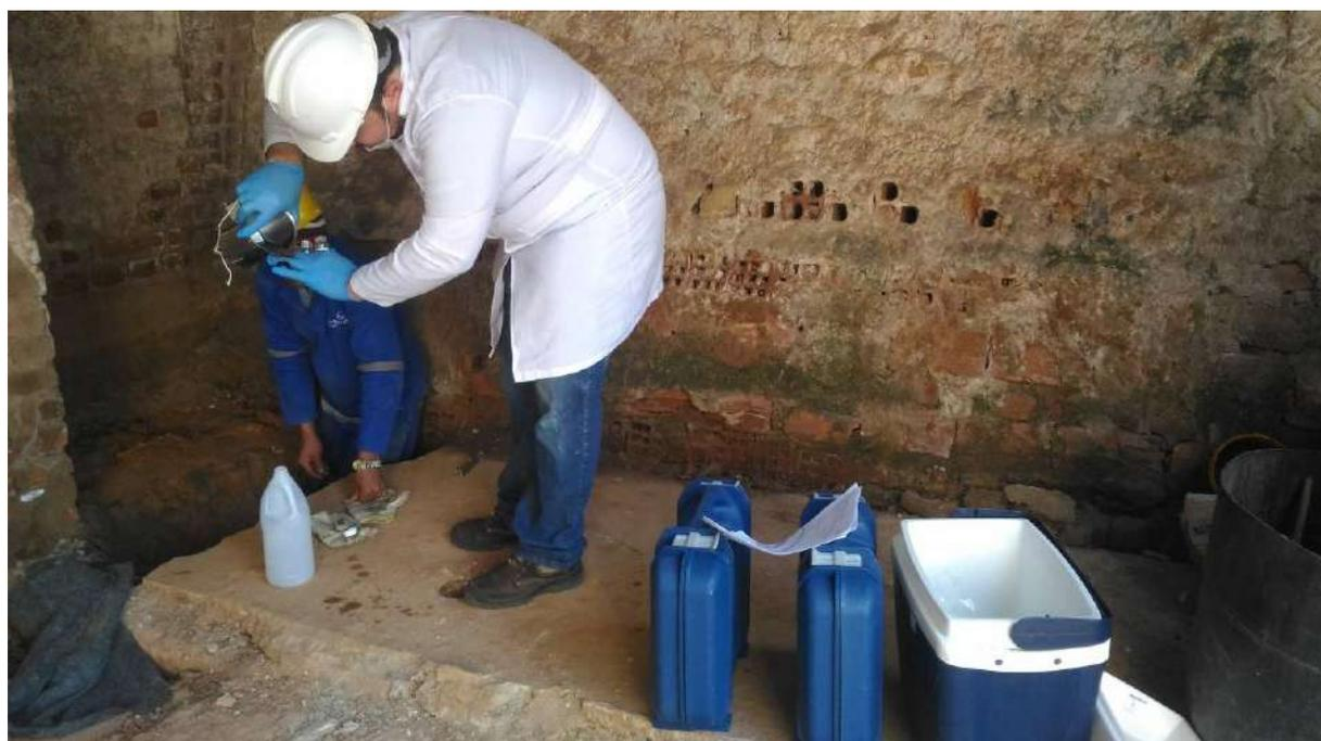
Foto 20 Coleta de amostra da água para análise microbiológica
