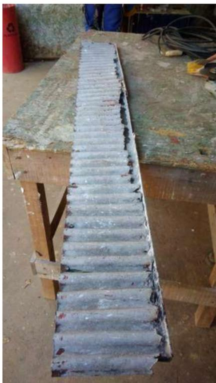
Foto 88: Chapa ondulada da fachada que foi substituída;
