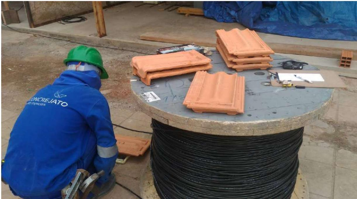
Foto 15: Ensaio de impermeabilidade das telhas francesa
