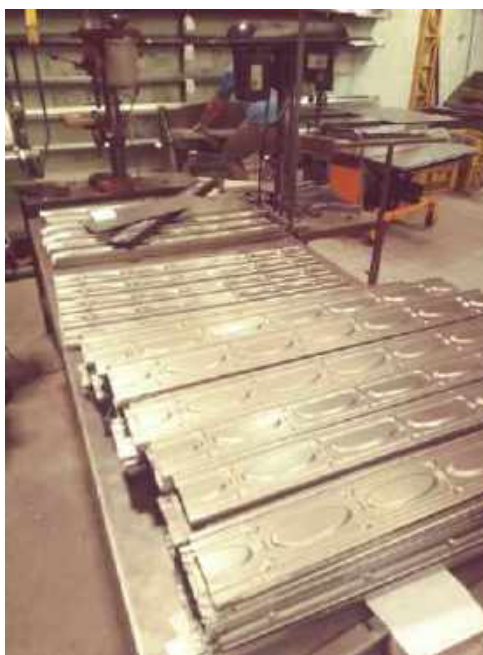
Foto 34 – Execução do forro metálico – Casa 06
